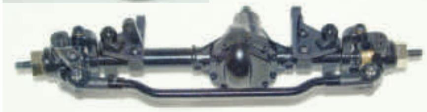
Die beiden K44-Achsen sind aus Vollmetall. An der Vorderachse arbeiten CVDs.
