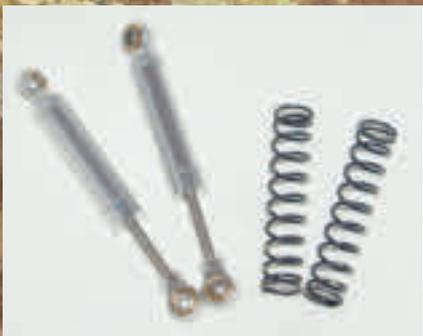
Dämpfung und Federung sind bei diesem Chassis getrennt
