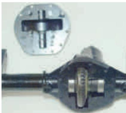
Hier sieht man den kugelgelagerten, geradeverzahnten, starren Stahldurchtrieb
