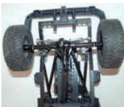
Die Hinterachse verfügt über eine klassische Vier-Link-Aufhängung
