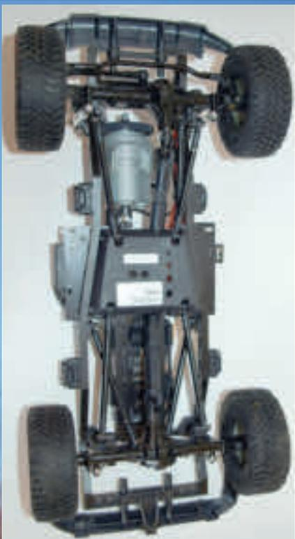
Die Unterseite des Cross-Country-Chassis mit der flachen Skid-Platte
