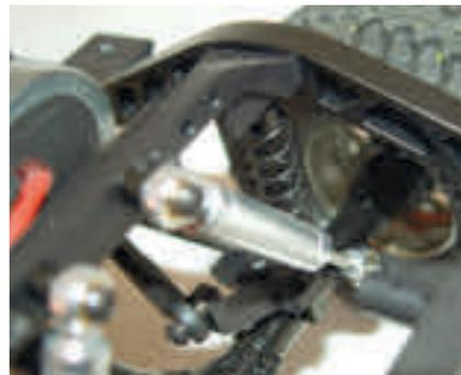
Man erkennt die Ausfräsungen am Chassisrahmen. Dämpfung und Federung sind getrennt verbaut.
